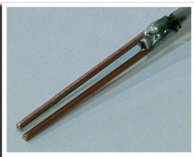
manera conseguiremos que la resistencia mecánica ofrecida al giro de las hojitas esté dentro de los márgenes adecuados. Para terminar esta parte del instrumento, colocaremos una pequeña funda termoretráctil al cable coaxial escondiendo su malla y dando a nuestro electroscopio un toque cuasi profesional.
