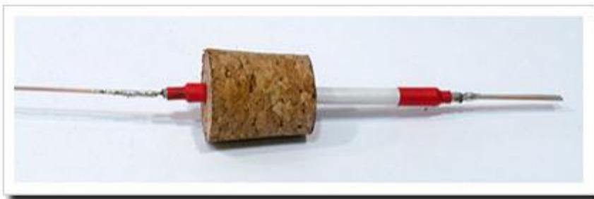
Al extremo superior del cable coaxial soldaremos otro trozo de alambre
